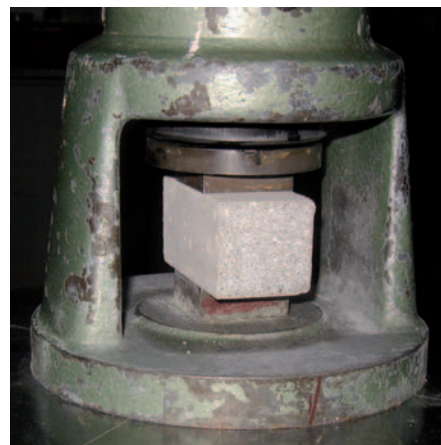
Afb. 3 Druksterkteproef volgens de NBN EN 1015-11 op metselmortel [14].
