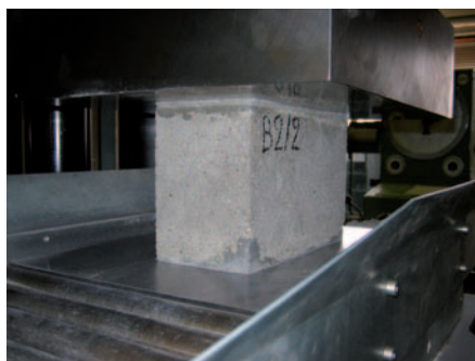
Afb. 2 Druksterkteproef volgens de NBN EN 772-1 op een betonmetselsteen.
